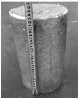
图 6 搅拌铸造法制备的 SiC p /A357 复合材料铸锭
